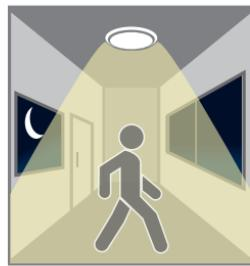
En cas de luminosité insuffisante (<20 lux), lorsque un mouvement est détecté, la lumière S'ALLUME.
