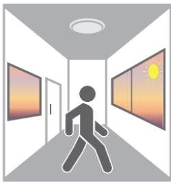
Lorsque la luminosité ambiante est suffisante (>20 lux), même en cas de détection de mouvement, la lumière reste ÉTEINTE.
